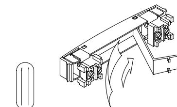
Colocación de las etiquetas de pulsadores y ajustes del nivel de audio.
