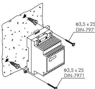
Instale el transformador en un lugar protegido. Recuerde que la normativa vigente obliga a proteger el transformador con un interruptor magneto térmico.
